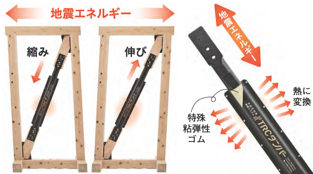
「TRCダンパー」は地震エネルギーを吸収し熱エネルギーに変換する
